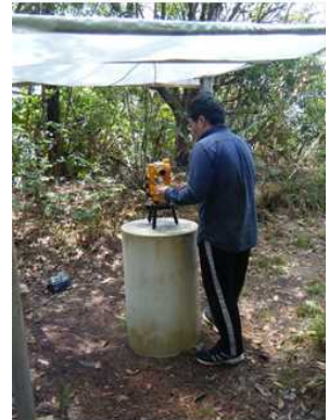
DIメータによる絶対観測 上：女満別観測施設 下：父島地磁気観測点
