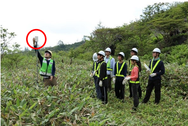
写真1 全磁力観測の様子。○で囲まれているのがプロトン磁力計のセンサー部。
