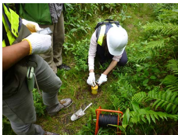
写真2 自然電位の測定
