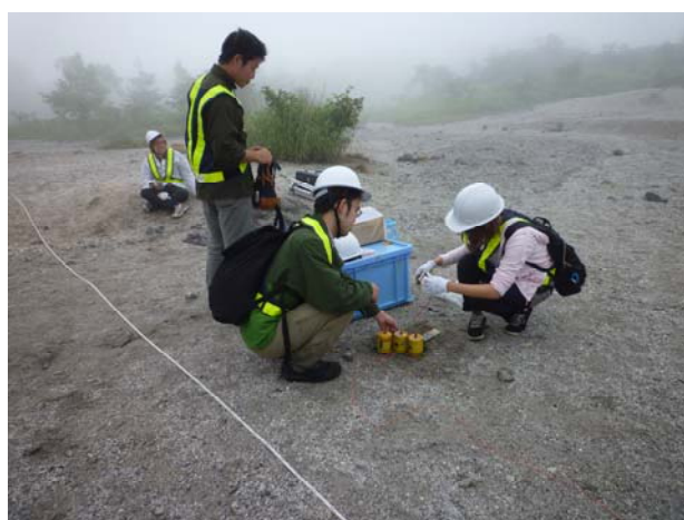
写真1 自然電位観測前の電極のテスト
