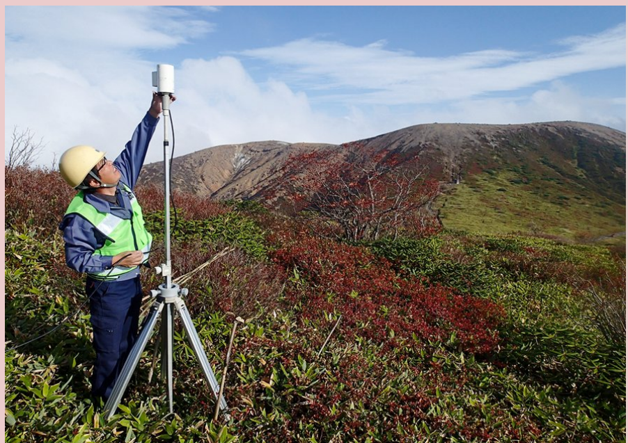
写真2 磁力計センサー取付の様子(写真は技術課山崎主任研究官)
