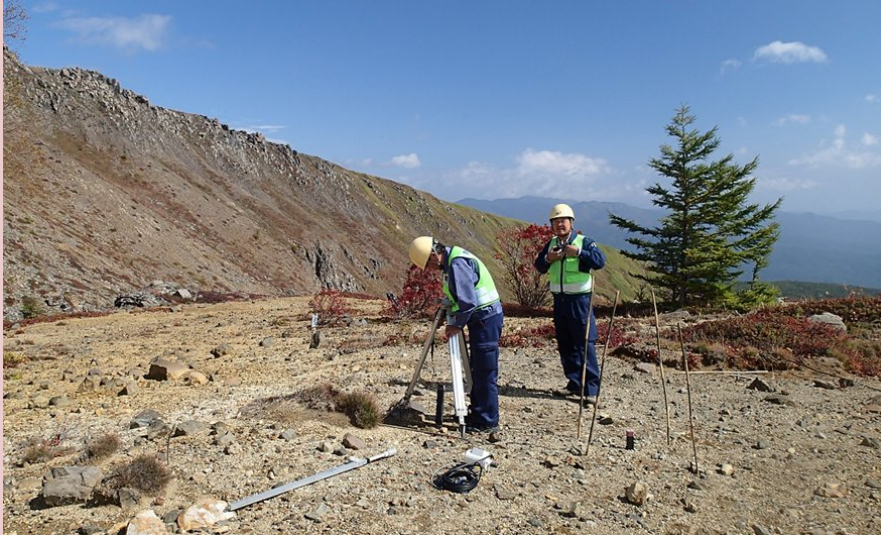
写真1 センサー設置の場所と方角を確認する作業
